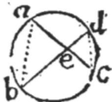
66. Si  $a c$  est diamètre du cercle, &  $d b$  perpendiculaire,  $d e$  ou  $b e$  sera moyenne proportionnelle entre  $a e$  &  $e c$ , à cause que  $d e$  sera égale à  $e b$  : ( 4. 6. ) ainsi  $a e . d e :: b e . e c$  & le carré  $d e$  sera égal au rectangle  $a e c$ .
